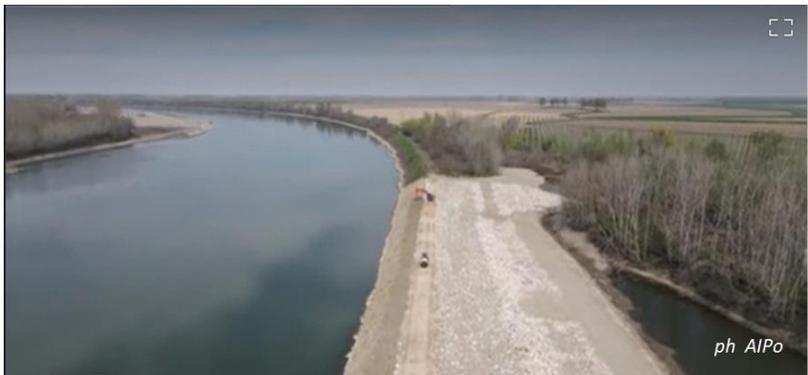
Lo scopo del progetto è quello di aumentare la frequenza delle esondazioni dall'alveo principale del Po verso l'alveo secondario (lanca) e conseguentemente diminuire la portata nell'alveo principale durante i grandi eventi di piena.
